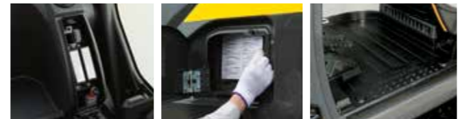
Koltuk arkasında merkezi sigorta kutusu | Klima filtresine kolay erişim | Yıkanebilir kabin zemini ve taban paspasları
