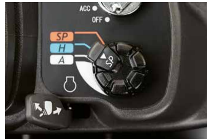
Entegre Gaz Kelebeği Modu Seçici Gaz modları seçimi, kolayca düğmeyi çevirerek yapılabilir. Böylece operatör kolayca optimum çalışma moduna geçiş sağlar.
