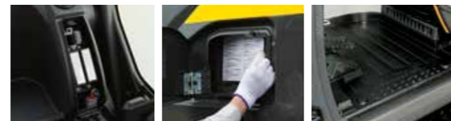
Koltuk arkasında merkezi sigorta kutusu | Klima filtresine kolay erişim | Yıkanebilir kabin zemini ve taban paspasları
